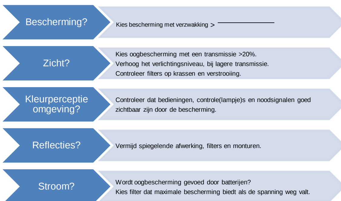
Figuur 7 - Enkele criteria bij keuze oogbescherming (bron: Non-binding guide)
