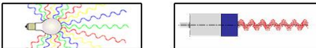
Figuur 2 - Verschil niet-coherente en coherente (laser) straling
